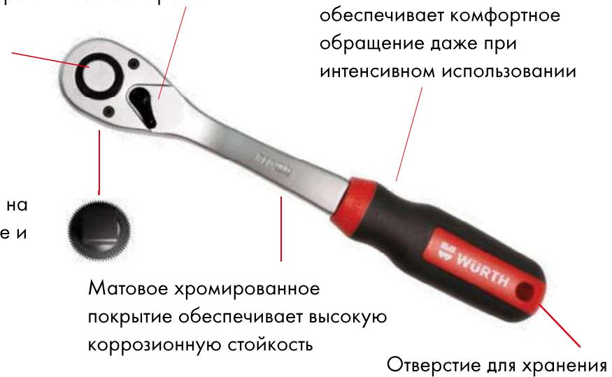
72-зубчатая передача с поворотным рычагом на 5градусов обеспечивает точное перемещение и простоту использования в ограниченном пространстве
