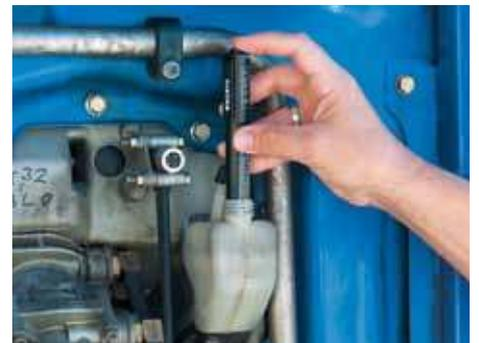
**Тестер для тормозной жидкости**
